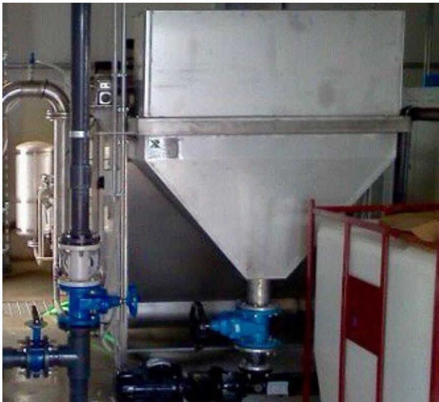
di saturazione, dove avverrà il contatto con l'aria, e in seguito viene rinviata all'ingresso del refluo saturo d'aria, in modo da permettere la spinta verso l'alto dei SST presenti nel refluo.
