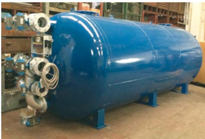
L'esecuzione standard prevede lamiere e profilati in acciaio al carbonio protetto esternamente con ciclo di pittura epossidica ed internamente con smalto epossidico ad alto spessore per uso alimentare; uno o più passi d'uomo, supporti di appoggio, golfari di sollevamento, valvole, diffusori, manometri, tubazioni d'ingresso e d'uscita opportunamente flangiate.
