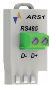
L'interfaccia seriale RS485 permette di collegare fino a 30 strumenti con un unico master remoto. La lunghezza del cavo non deve superare i 1500 m alla velocità di comunicazione di 9600 baud. A seconda del modello cui va collegato il convertitore, esistono due tipi diversi di cavi: CATTL Don oppure CATTL Ion.
