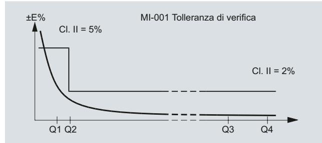
La tabella seguente mostra gli intervalli di misurazione per i prodotti MAG 5100 W (7ME6520) verificati e dotati di marcatura MI-001 per un Q3 e Q3/Q4 = 1,25 e Q2/Q1 = 1,6 dati:
