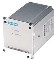
Per la pulizia degli elettrodi nell'ambito del trattamento delle acque specifiche, i depositi indesiderabili vengono eliminati mediante l'applicazione di una tensione CC o CA a livello degli elettrodi. La pulizia CA è utilizzata per le applicazioni di trattamento delle acque di scarico. Il riscaldamento degli elettrodi permette di eliminare i depositi grassi. La pulizia CC viene impiegata nelle applicazioni di riscaldamento a distanza al fine di eliminare i depositi a conducibilità elettrica.
