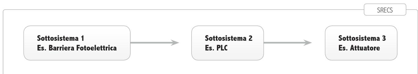
Fig. 8 - Architettura tipica della realizzazione tecnica dello SRECS
