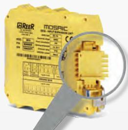
I connettori del bus proprietario MSC sono fisicamente localizzati sul retro di ogni modulo e trovano posto nella barra omega del quadro.
