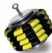
**STRONG** assemblato con viteria passante ha superato i severi test di resistenza dinamica **per l'impatto dall'interno verso l'esterno a 1600J** secondo la procedura "del corpo rigido" contenuta nella norma EN ISO 14120
